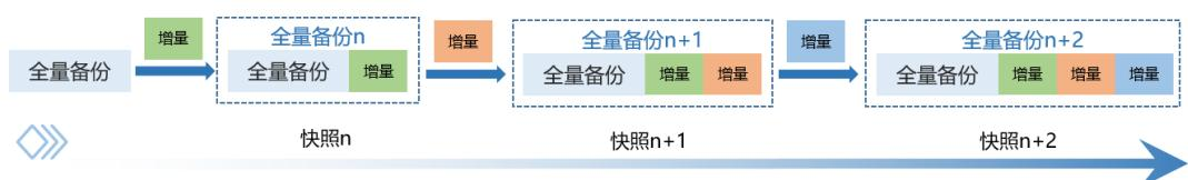
THE CDM云数据管理软件，采用“初次全备+永久增量”的备份策略，初次进行数据全量备份后，后期自动将当次的增量备份集与上一次的备份集进行合并，并通过存储层快照进行历史数据的保存。通过自动合并技术，每一个存储快照的备份集均为一份完整备份的备份集，使用此备份集进行恢复或数据再利用时无需进行增量恢复，可有效提高数据使用效率。
